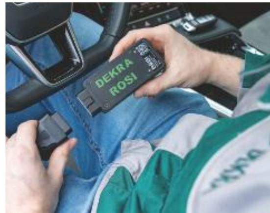
**Prüfstand „to go“:** Ein neuer Batterie-Schnelltest soll in 15 Minuten Klarheit bringen, wie es um den Akku eines Elektroautos bestellt ist.
